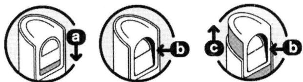
1. Большим пальцем плавно опустите вниз кнопку дозатора, как показано на рисунке (а), до возможности нажатия кнопки внутрь (см. рис. б).
